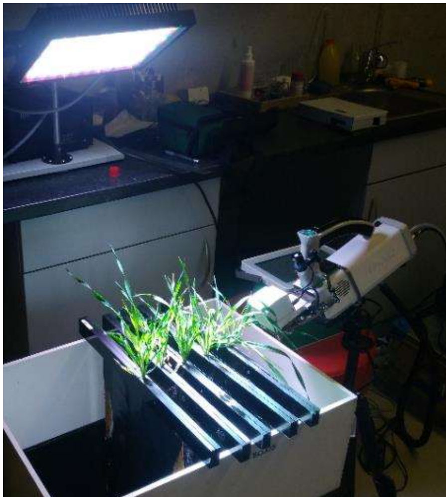
Obr. 12 Měření fotosyntetických parametrů pomocí přístroje Li-6800 na rostlinách ječmene kultivovaných na fenotypovacích jednotkách
