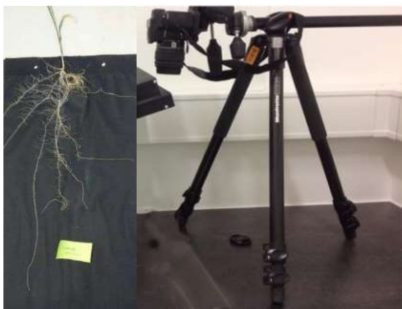
Obr. 5 Snímání kořenů pomocí digitální kamery Pentax K-x ze vzdálenosti asi 60 cm (vpravo) a snímek kořenového systému ječmene (vlevo).
